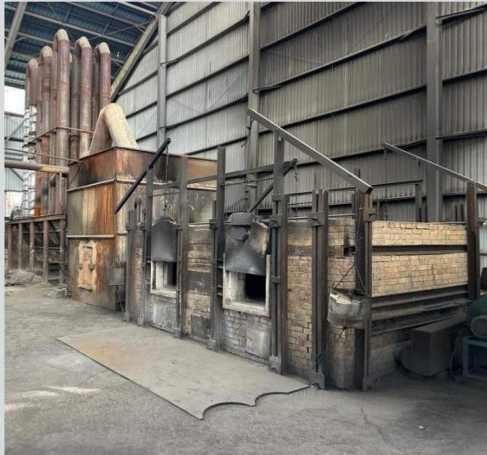
该厂还有一个熔化锑锭的熔炉，日产量为 5 吨。
