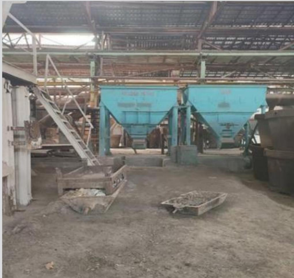
值得注意的是，该选矿厂自 2004 年以来就没有运营过。截至 2021 年 10 月 1 日，选矿厂的工程已经完工。对厂房进行了大修，更换了厂房设备、破碎设备和浮选机。计划在不久的将来将选矿厂投入全面运营。
