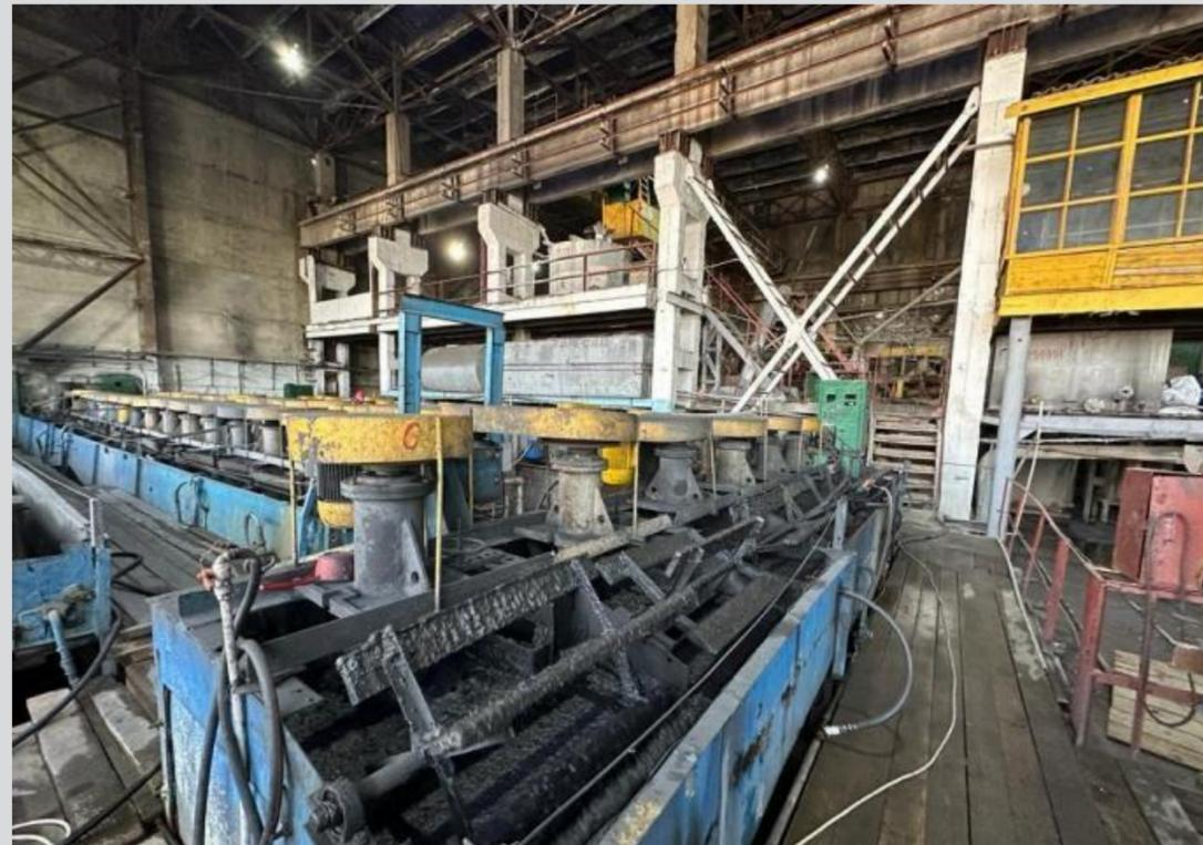
我们拥有日产量 1000 吨的破碎机。破碎后的矿石在磨机中经过 3 个阶段的研磨，然后进行浮选。我们的精矿精选率高达 69%。
